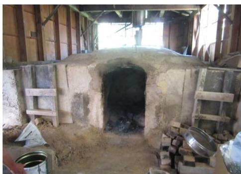
伝統的な炭焼窯(閉鎖的ドーム構造)
