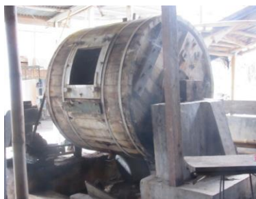
皮なめし工程等で用いているドラム
