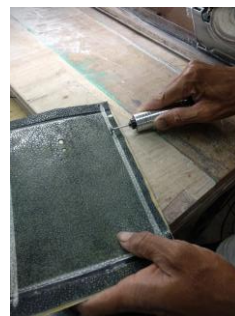
セラミック切削工具による縫製の下準備
